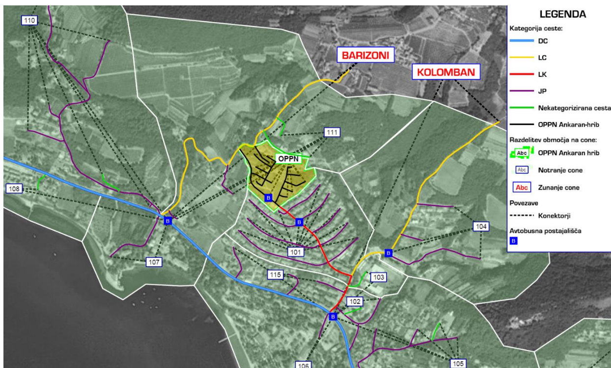
Slika 25: cestna mreža in coning v prometnem modelu Ankarana na območju OPPN Ankaran hrib
